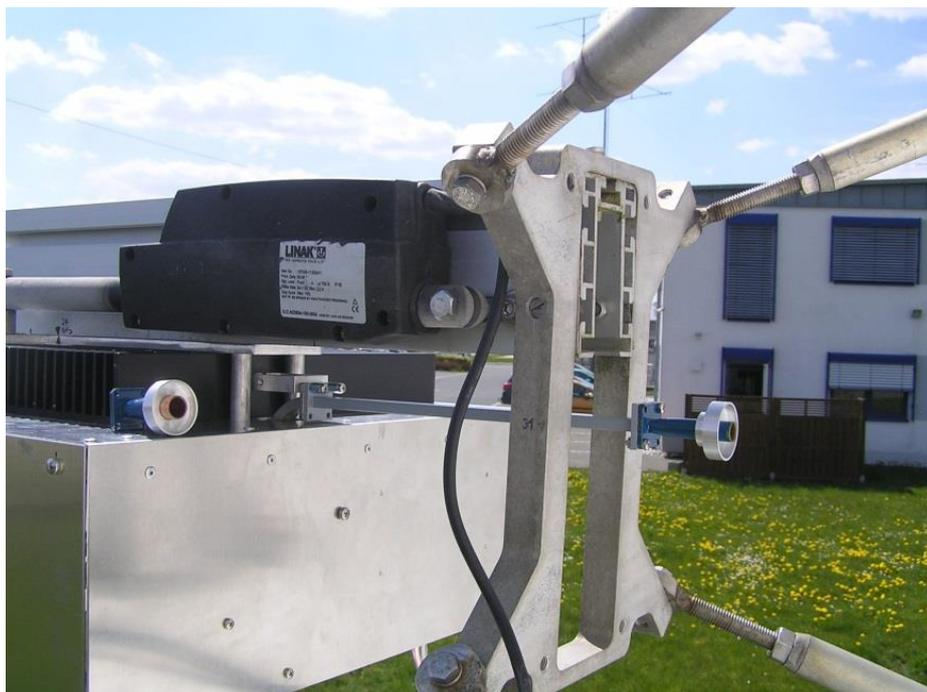
Der gesamte Transverter ist mit einem Schlitten und einem Aktuator im Abstand zum Parabolspiegel verstellbar und kann dadurch im Focus Punkt optimiert werden. Der Strahler ist eine skalierte Version des VE4MA Superfeed (Dank an DC7KY). Ich habe verschiedene Hohlleiterdurchmesser und Strahlerversionen vermessen. Die Unterschiede waren dabei sehr gering und auch nur schwer reproduzierbar zu messen.
