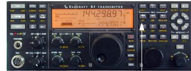
K3 Ausgangsleistungsregler PWR – auf 1,5 mW
