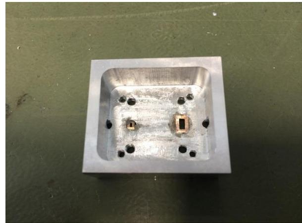
Danach wird die Leiterplatte mit Silberleitkleber eingeklebt. Zur optimalen Positionierung wird eine rote Power LED als Lichtquelle verwendet. Das durch die Leiterplatte scheinende Licht ist an den Hohlleiterübergängen gut sichtbar.
