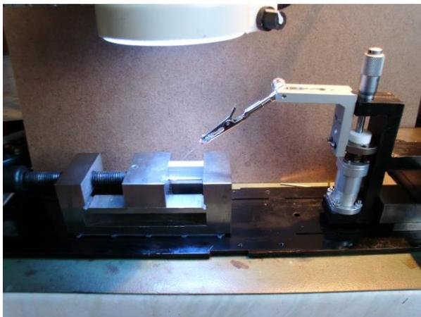
Eigenbau Mikromanipulator zum Positionieren von Leitkleber und Dioden.
