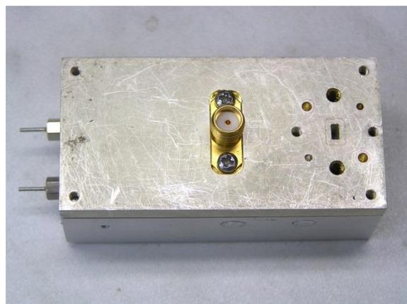
Nachfolgend ist eine Variante eines „auf der Leiterplatte integrierten Dioden-Verdreifachers“ beschrieben. Erste Versuche waren sehr ermutigend. Dabei wurde eine „Dreifach-Diode“ der Firma **ACST** eingesetzt. Leider können hier noch keine Messwerte veröffentlicht werden, da uns derzeit noch kein kalibriertes Powermeter zur Verfügung steht.
