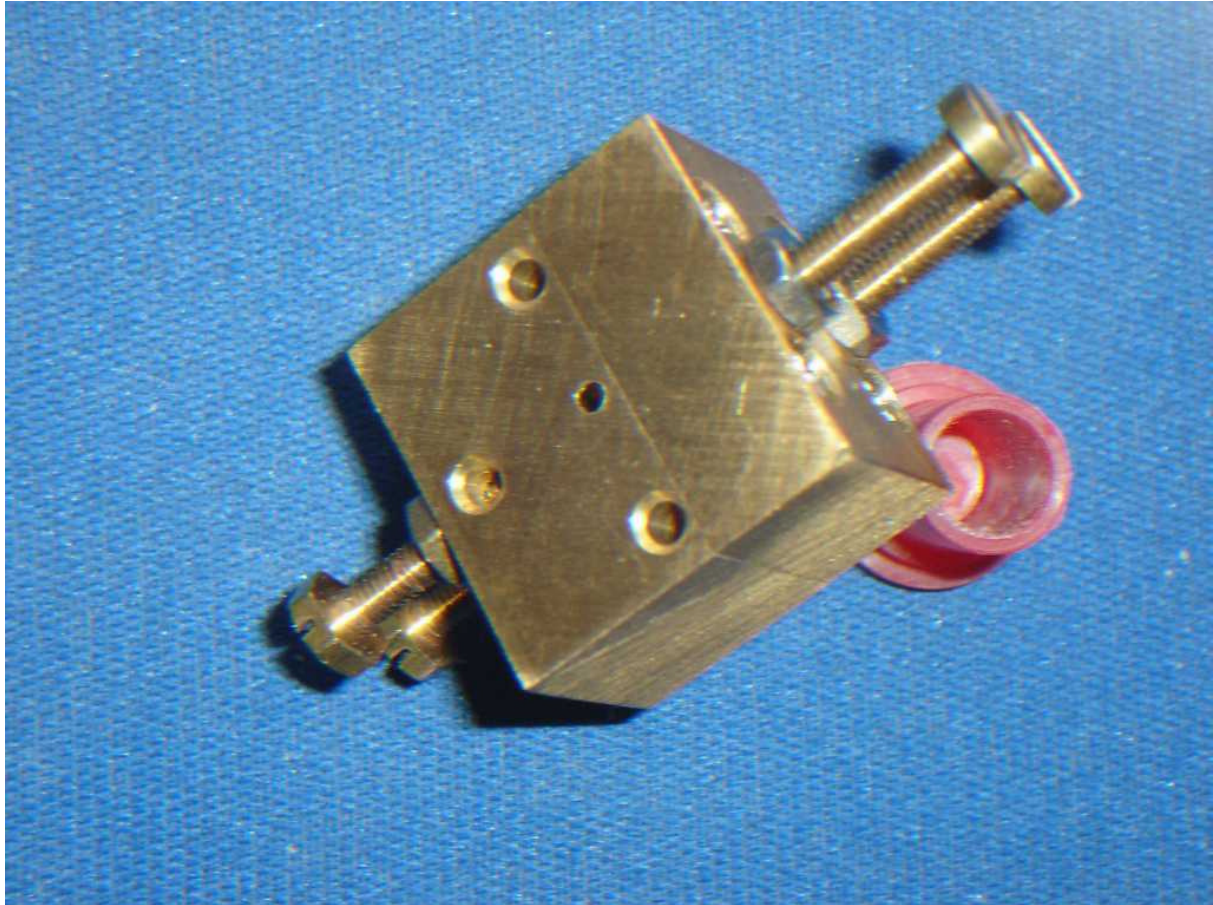
(Bildunterschrift B.5: umgebautes Resonatorfilter für 67 GHz)
