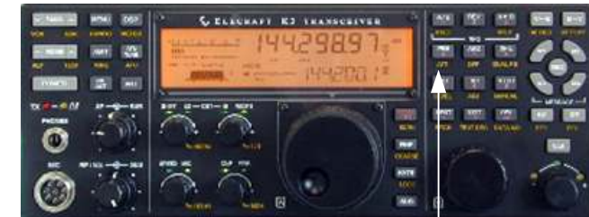
K3 Ausgangsleistungsregler PWR – auf 1,5 mW
