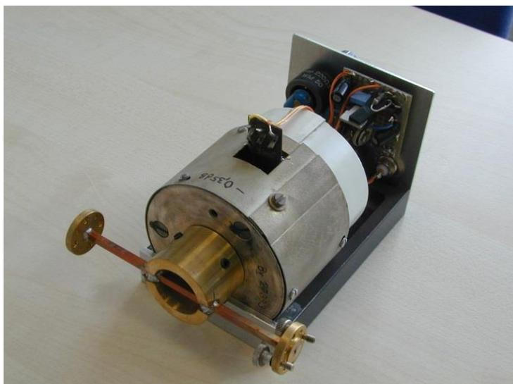
Dabei wird mittels eines Elektromagneten, der über einen Verstärker angesteuert wird, ein Absorbermaterial in den Hohlleiter eingetaucht. Dieser bietet gleichzeitig eine gute Anpassung. Gesteuert wird die Anordnung durch den 28 Volt Ausgang des Rauschmessgerätes.
