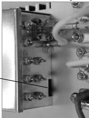
Schalter zu Pin 2 (PTT-Steuerung einer externen PA)
