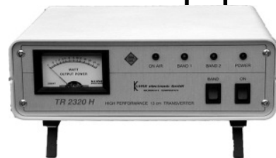
Version D: TR 2320 H mit Antennenrelais und Empfangsvorstufe an der Antenne sowie Leistungsstufe
