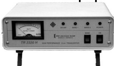
Version C: TR 2320 H mit Antennenrelais und Empfangsvorstufe an der Antenne
